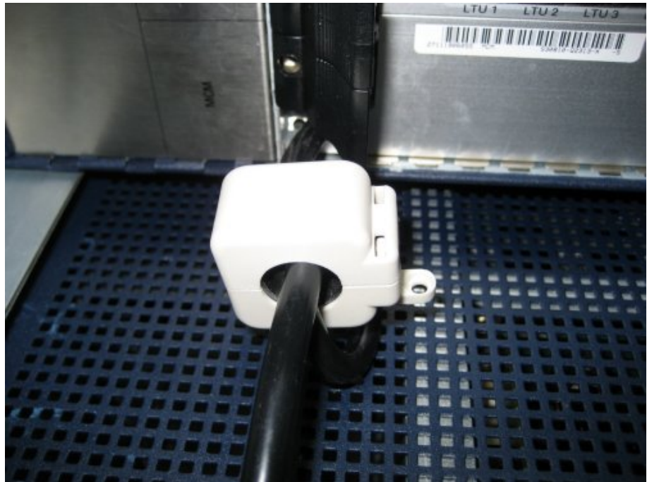
Abbildung 39: Geschlossener Ferritkern mit AC-Leitung
