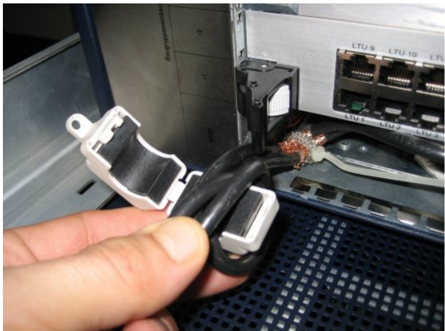
Abbildung 44: Schleife der DC-Leitungen durch den Ferrit
