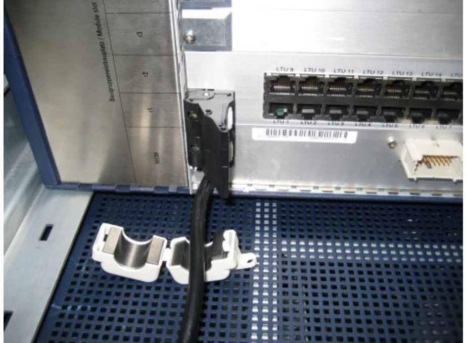
Abbildung 37: Ferrit offen unter AC-Leitung
