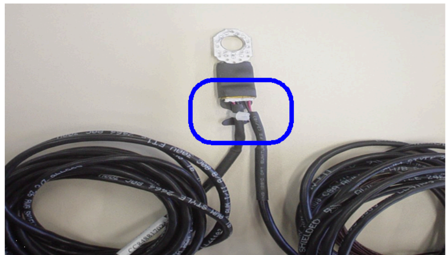
Abbildung 145: Anschluss des Temperaturfühlers für Baugruppenrahmen A und B
