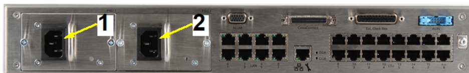
Abbildung 104: AC-Stromversorgung des EcoServers
