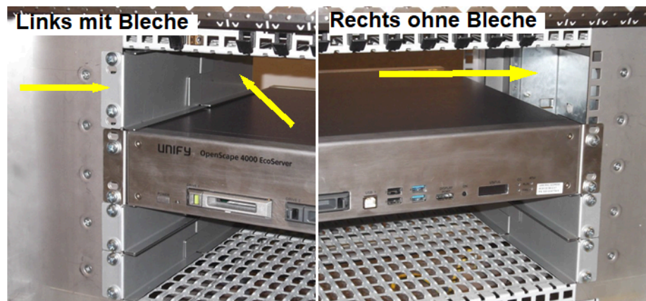
Abbildung 25: Luftleitbleche über EcoServer bei Simplex Betrieb
