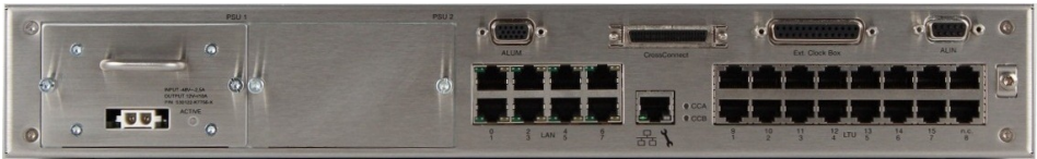
Abbildung 111: DC-Stromversorgung des EcoServers
