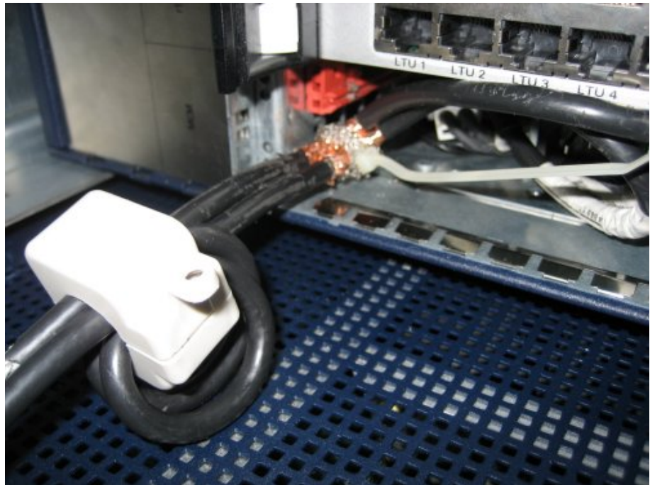
Figure 43: Núcleo de ferrita cerrado con cables c.c.
