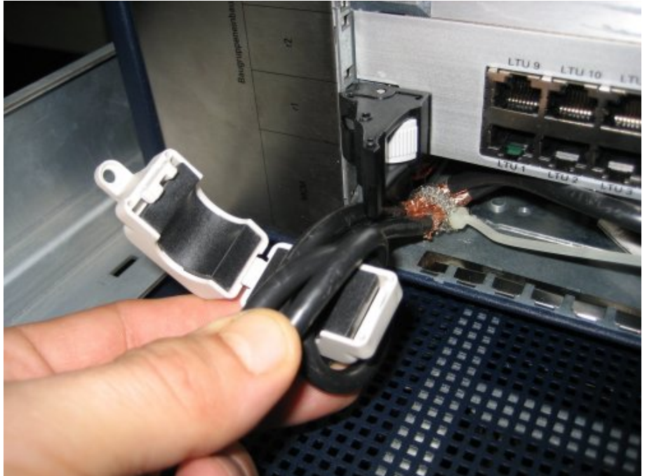
Figure 42: Cables de c.c. superpuestos sobre el núcleo de ferrita
