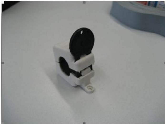
Figure 46: Llave presionada en el alojamiento del núcleo de ferrita
