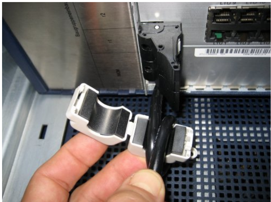
Figure 36: Cable de c.a. superpuesto sobre el núcleo de ferrita
