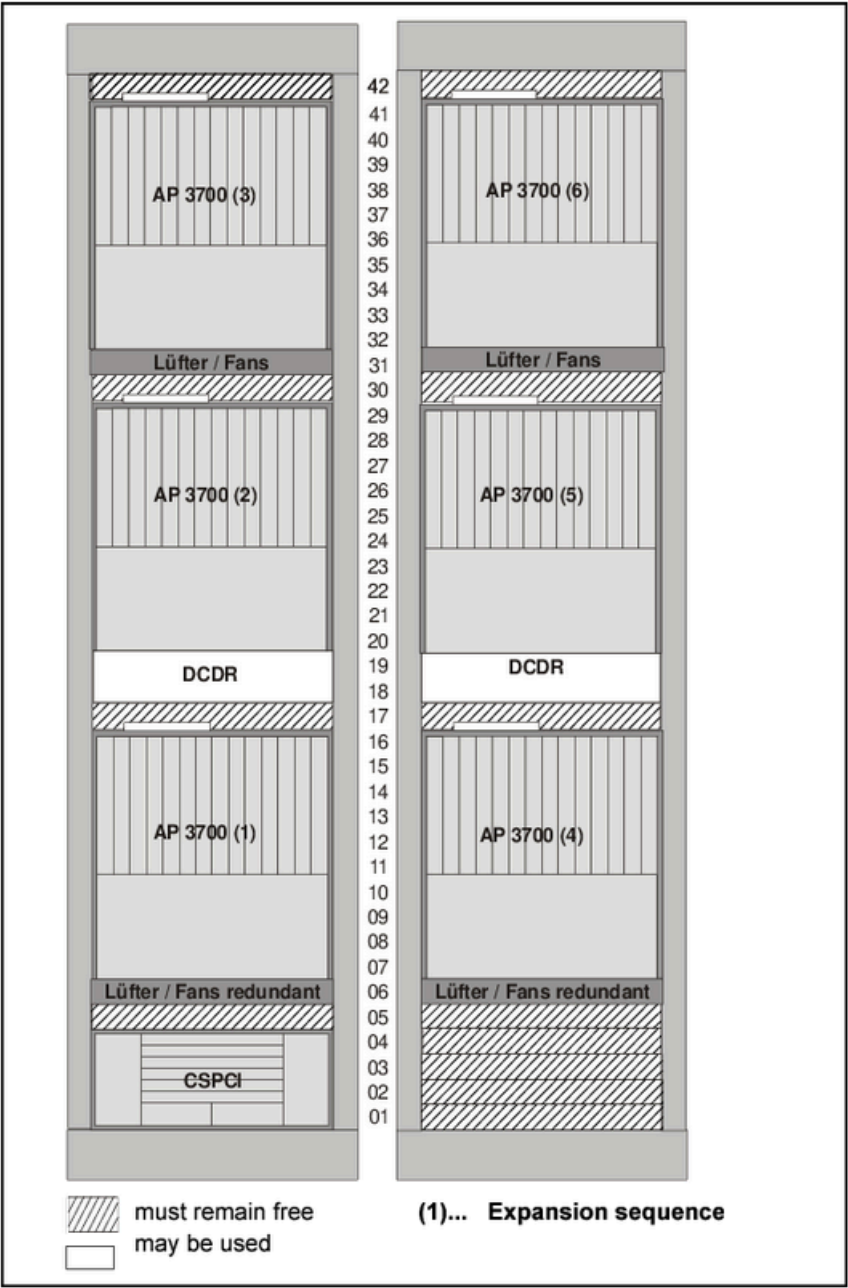
Figure 72: Montaje de CSPCI con AP 3700 en armario con 42 unidades de altura
