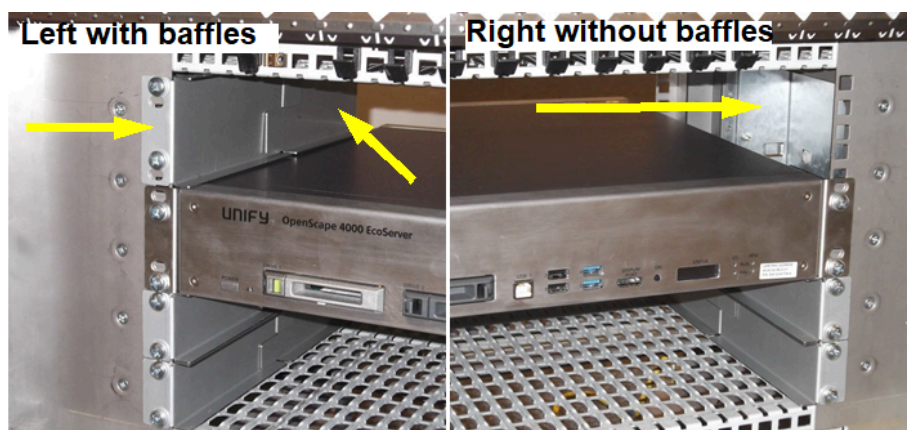
Figure 23: Chapas deflectoras por encima del EcoServer en uso en simplex
