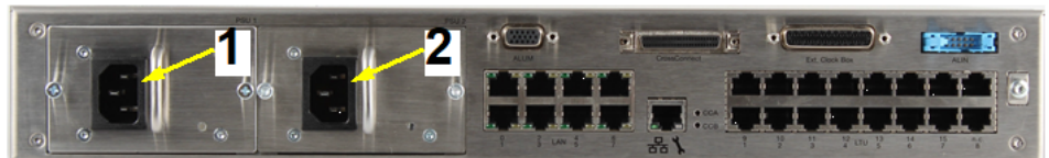
Figure 103: Alimentación eléctrica AC del EcoServer
