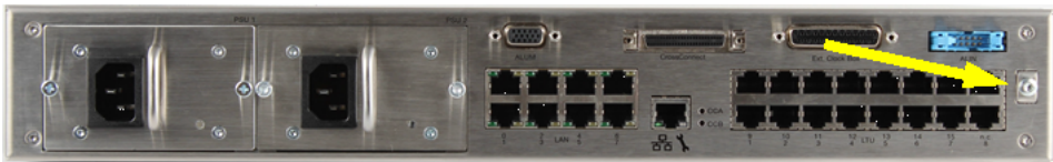
Figure 87: EcoServer - conexión equipotencial
