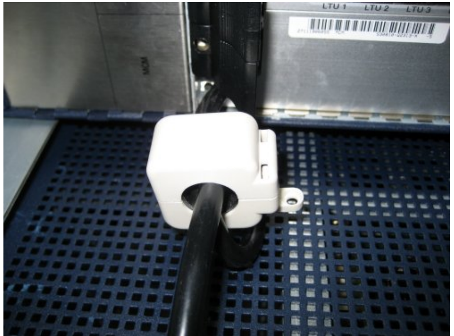
Figure 37: Núcleo de ferrita cerrado con cable c.a.
