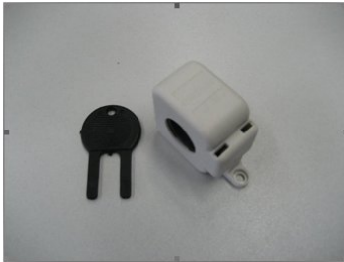
Figure 45: Llave y núcleo de ferrita cerrado
