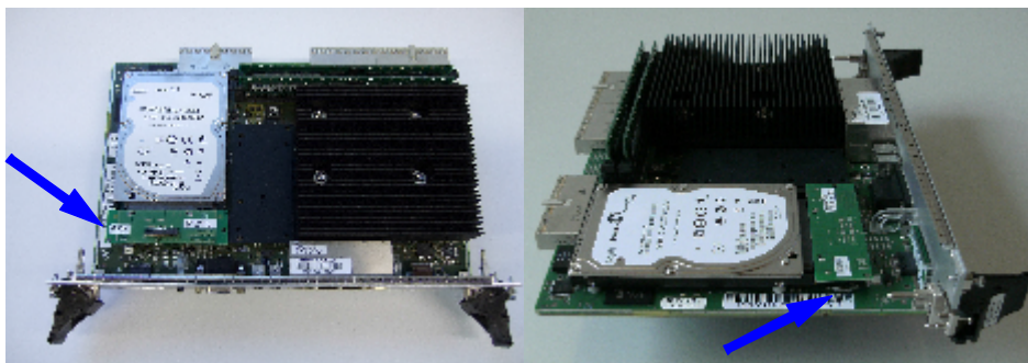
Figure 205: Batería en el módulo DSCXL2
