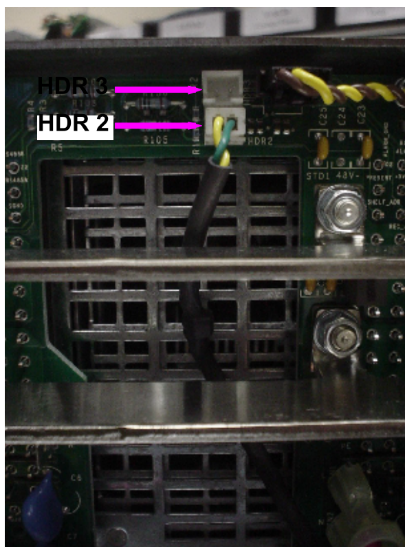
Figure 131: Connecteurs de référence HDR2, HDR3
