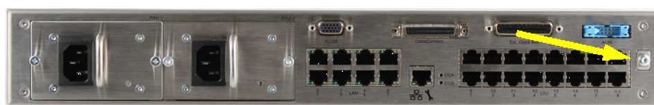
Figura 122: EcoServer - Ligação equipotencial
