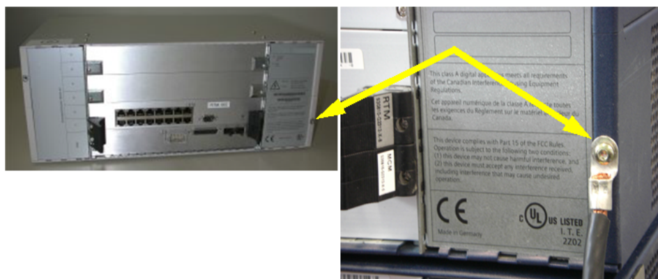
Figura 121: Placa traseira CSPCI - Condutor de ligação equipotencial
