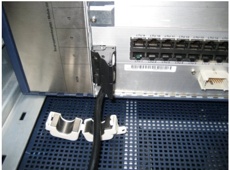
Figura 47: Núcleo de ferrite aberto sob o cabo AC
