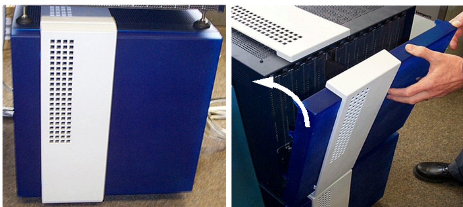
Figura 14: Retirar a tampa do AP 3700-9
