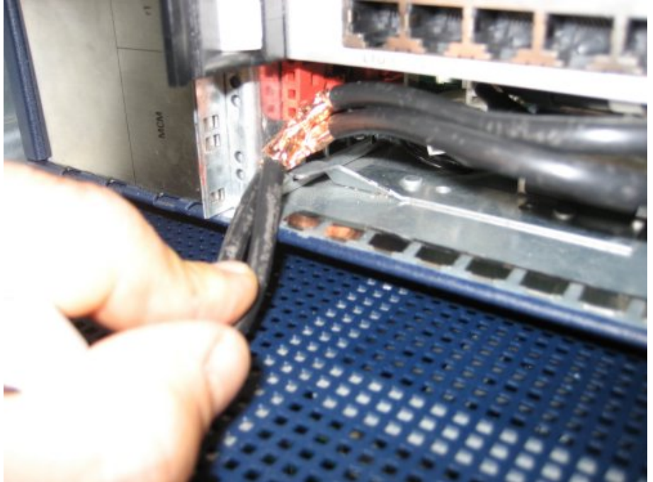
Figura 50: Cabo DC descarnado
