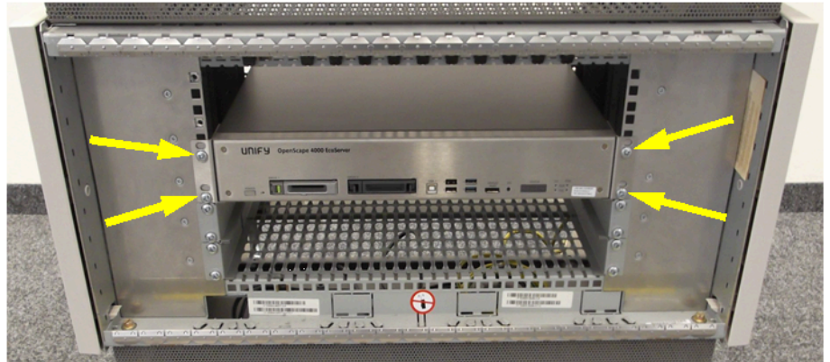
Figura 43: Montagem do EcoServer
