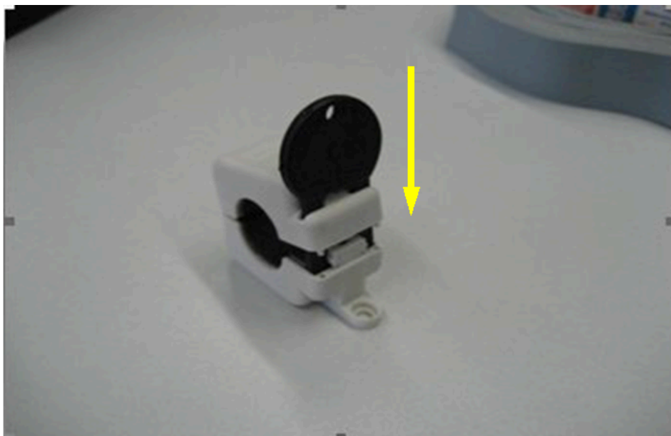
Figura 58: Compressão da chaveta na carcaça do núcleo de ferrite
