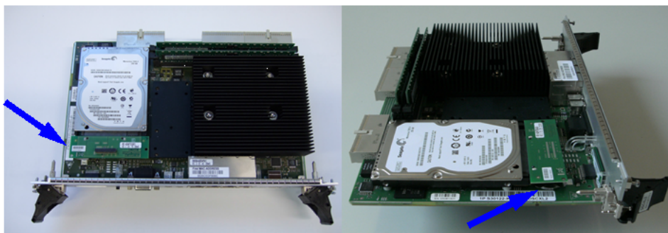
Figura 240: Bateria no módulo DSCXL2
