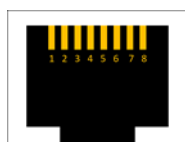
Figura 21: DIUT3 - Asignación de PIN de la toma RJ45 del panel frontal
