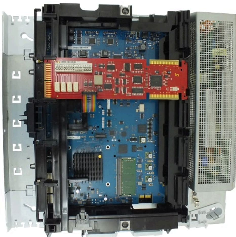
Figura 98: OpenScope Business X3W con OCCMB y STRB montado
