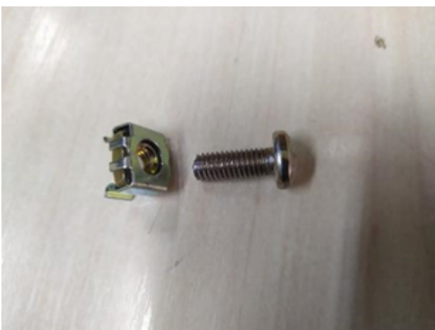
Figura 13: Componenti di montaggio per fissaggio 19" (non inclusi)
