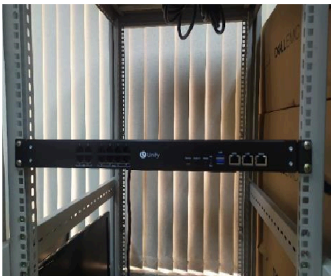
Figura 12: Esempio – Fissaggio 19" (binario verticale)
