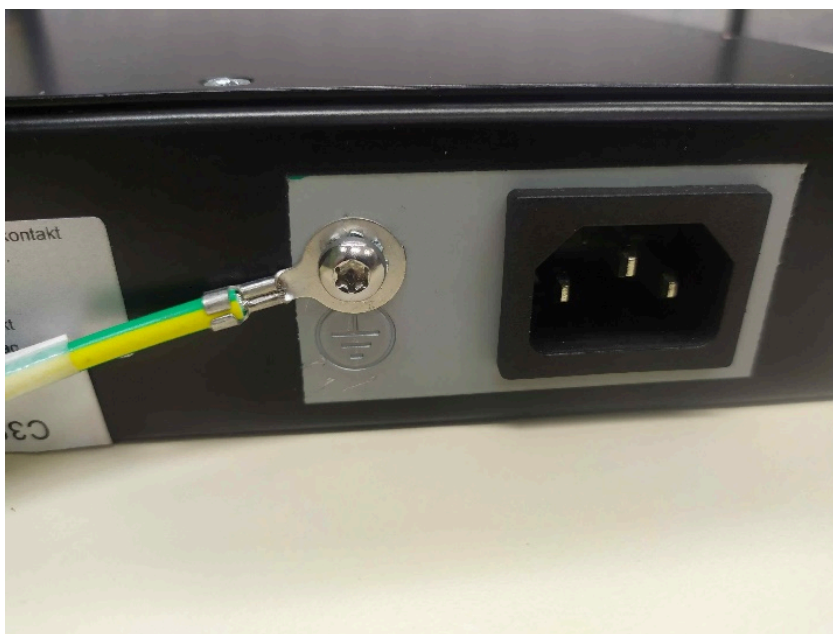
Figura 2: Assemblaggio del terminale di terra di protezione Montare il morsetto del cavo utilizzando la vite M4 e la rondella dentata.
