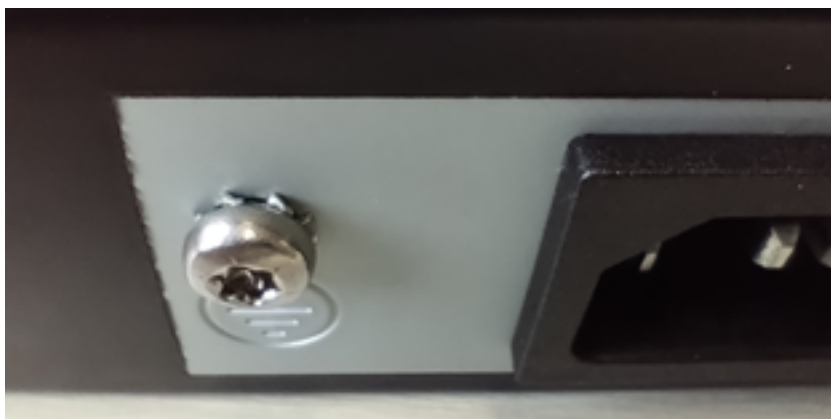
Figura 1: Attrezzatura per messa a terra di protezione
