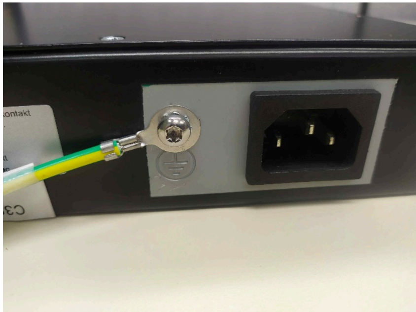
Figura 2: Montagem do terminal de proteção (terra)
