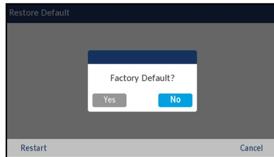
5. Wählen Sie mit der linken Navigationstaste **Ja** aus und drücken Sie die Auswahlstaste (mittlere Taste im Navigationscluster).
