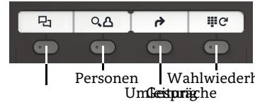
Das Telefon hat vier programmierbare Funktionstasten mit Status-LEDs, hier mit der Standardbelegung dargestellt.
