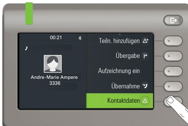
Gehen Sie mit der Taste
