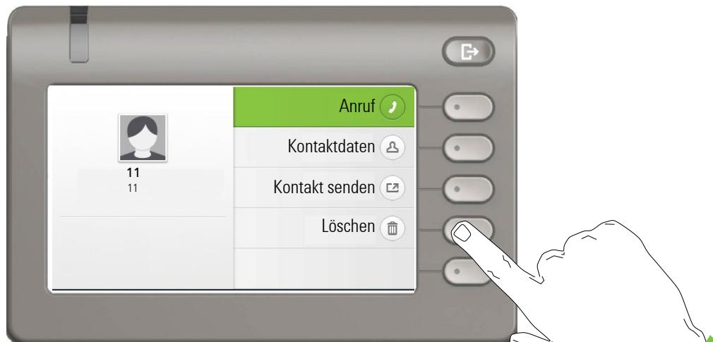
Drücken Sie den Softkey bei
