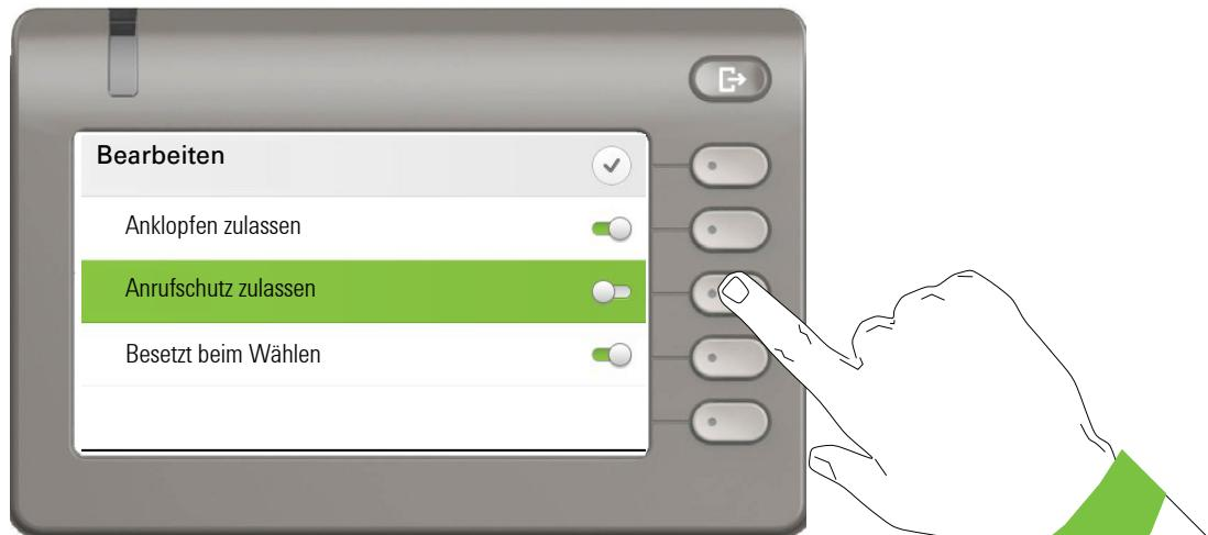
Auf den Softkey bei „Anrufschutz erlauben“ drücken, um die Funktion zuzulassen. Der Schalter wird nach rechts geschoben. Alternativ können Sie mit den Tasten und die Option auswählen und mit bestätigen, um die Schalter zu betätigen.
