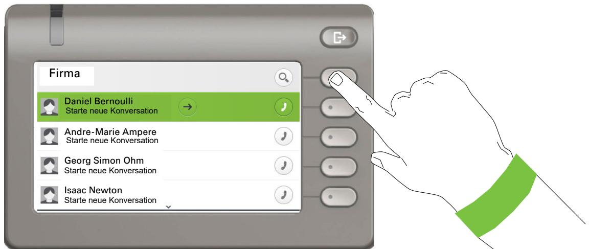
Öffnen Sie mit Drücken des Softkeys bei ein alphanumerisches Eingabefeld,
