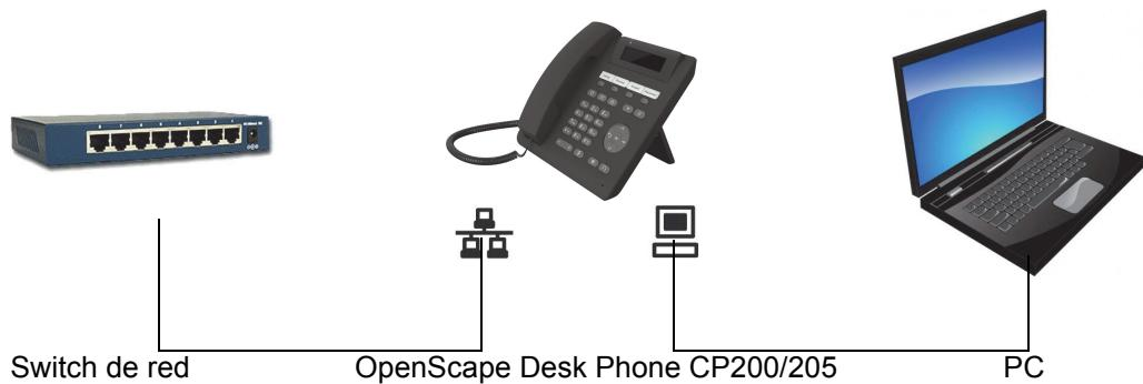
Gracias a este tipo de conexión se evita ocupar cada vez una conexión de red en el switch utilizado y, con una planificación idónea de las conexiones, se utilizan trayectos de cable más cortos.
