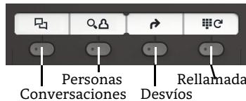
Su teléfono tiene 4 teclas de función programables con LEDs de estado, a la izquierda se muestra la configuración por defecto.
