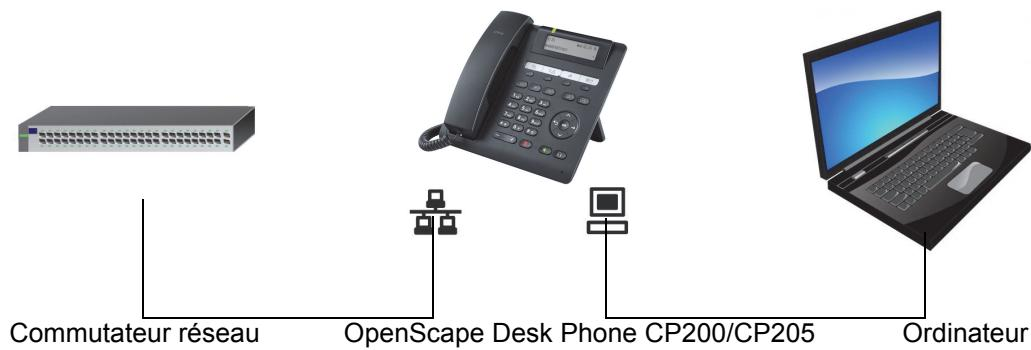
Ce type de raccordement vous permet d'économiser à chaque fois un point de raccordement au réseau sur le commutateur employé et d'utiliser des lignes plus courtes avec un agencement correspondant.
