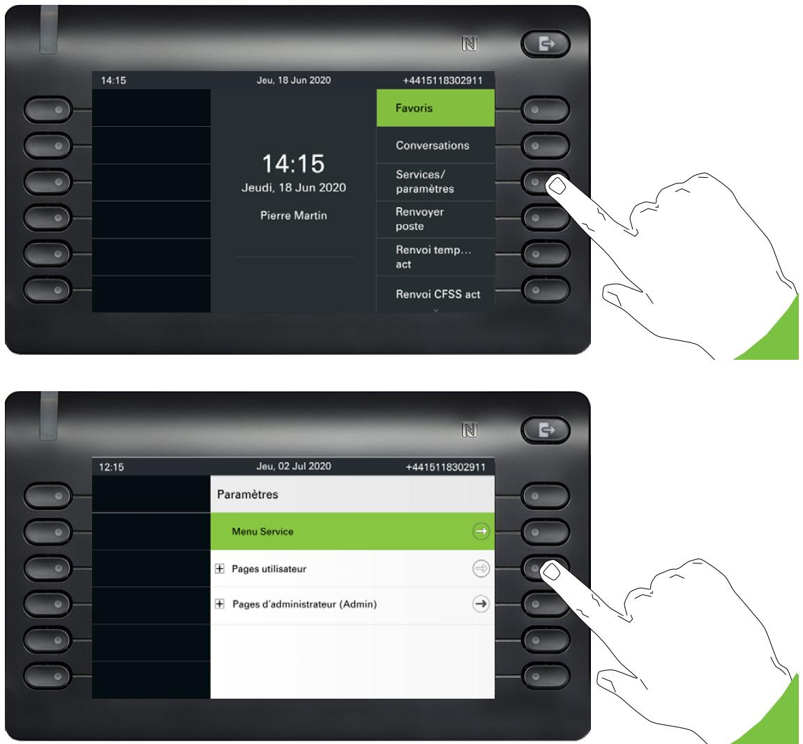
Le menu se compose d'une zone de configuration pour les paramètres du système, de l'utilisateur local et de l'administrateur local.
