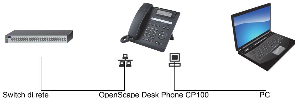
Questo tipo di connessione consente di risparmiare rispettivamente un'interfaccia di rete dello switch utilizzato e richiede un cablaggio più breve con una disposizione corrispondente.
