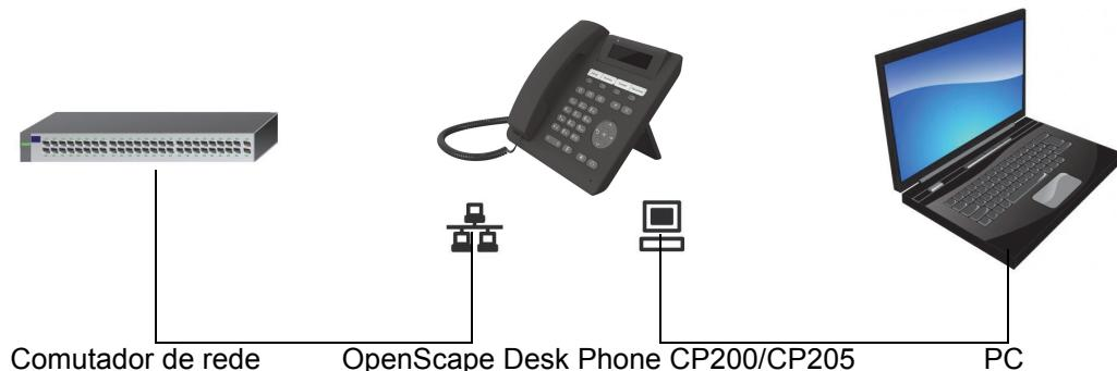
Com este tipo de ligação, economiza respetivamente uma interface de rede do switch utilizado. Além disso, com as ligações apropriadas, utiliza segmentos de cabo mais curtos.
