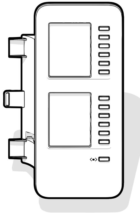
Le KM710 est un module d'extension optionnel à fixer et connecter au côté droit du téléphone. Il fournit 12 touches de fonction programmables supplémentaires sur deux niveaux avec voyants, soit 24 fonctions supplémentaires (voir "Touches de fonction programmables" → page 67).
