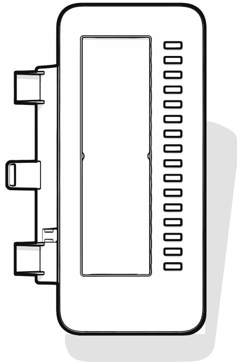
Le KM410 est un module d'extension optionnel à fixer et connecter au côté droit du téléphone. Il fournit 16 touches de fonction programmables supplémentaires sur deux niveaux avec voyants (voir "Touches de fonction programmables" → page 67).
