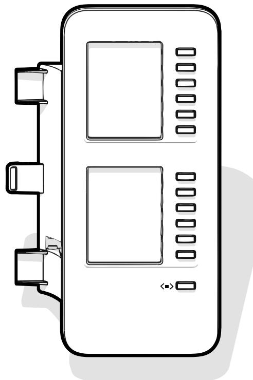
KM710 è un di espansione opzionale collegato e connesso al lato destro del telefono che fornisce ulteriori 12 tasti funzione illuminati e programmabili a due livelli, ossia 24 funzioni aggiuntive (vedere "Tasti funzione programmabili" → page 66).
