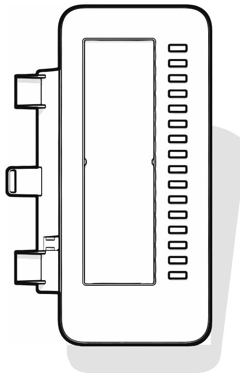
KM410 è un modulo di espansione opzionale collegato e connesso al lato destro del telefono che fornisce ulteriori 16 tasti funzione illuminati e programmabili (vedere "Tasti funzione programmabili" → page 66).
