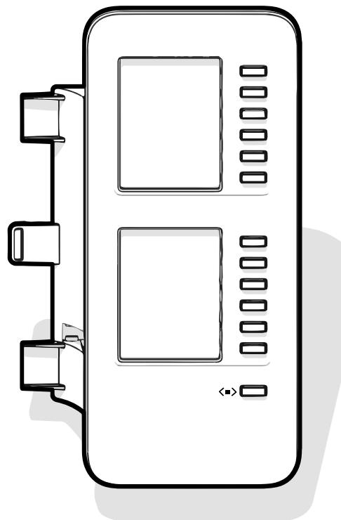
KM710 è un di espansione opzionale collegato e connesso al lato destro del telefono che fornisce ulteriori 12 tasti funzione illuminati e programmabili a due livelli, ossia 24 funzioni aggiuntive (vedere "Tasti funzione programmabili" → page 67).
