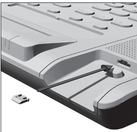
Montieren Sie eine der Hörerklemmen mit der **Schräge nach vorne** und mit den **Widerhaken zuerst** in der Ablageschale.
