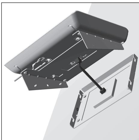
Stecken Sie das Netzwerkkabel\* in die entsprechende Buchse
