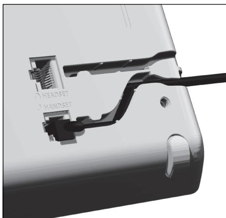
Stecken Sie den Stecker des **langen** geraden Hörerkabelendes in die entsprechende Buchse
