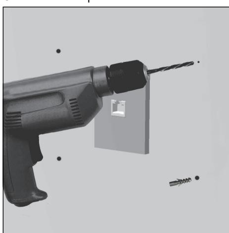
Bohren Sie die Löcher. Setzen Sie abhängig von der Beschaffenheit der Wand passende Dübel ein. Weiter mit Schritt 7 auf der Rückseite →
