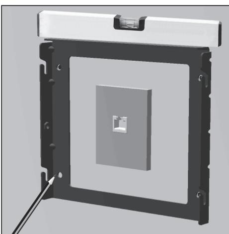
Positionieren Sie den Wand-Rahmen an der Wand und kennzeichnen Sie die Bohrlöcher.
