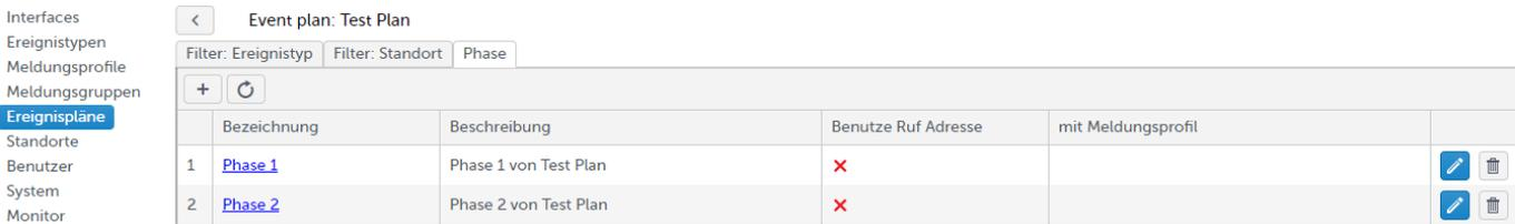
Durch Bearbeiten der Phaseinstellungen kann das Flag "Benutze Ruf Adresse" aktiviert und ein Meldungsprofil zugewiesen werden. Mit dieser Art der Konfiguration kann eine direkte Zuordnung von Rufadressen zu einer Meldungsgruppe mit dieser Adresse realisiert werden. In dem Eingangsinterface (z.B. ESPA) muss ein Endpunkt mit dieser Aufrufadresse konfiguriert werden.
